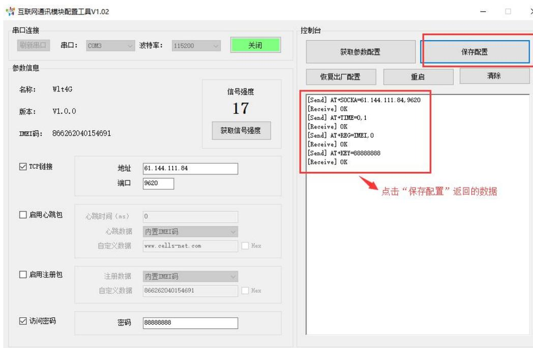
图 4-6 WGT2G/4GR 设备 4G 参数配置
