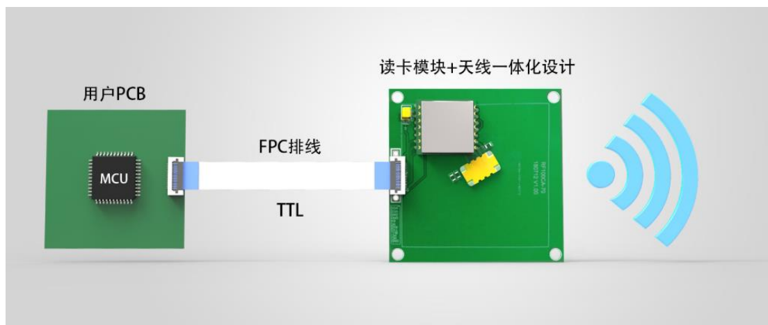
图 1-4 三线连接，仅一条指令就可以获取所有标签信息
