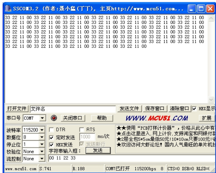
图 4-15 终端发送数据至主机
