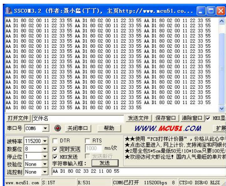
图 4-14 主机发送数据至终端
